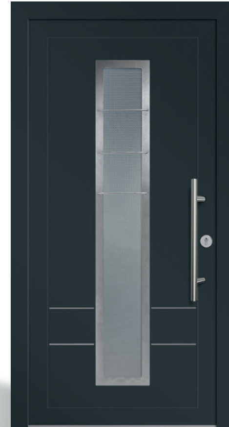
MKS01115 | Einsatzfüllung | Anthrazitgrau foliert genarbt | Lichtausschnitt: 1 x 270 mm x 1600 mm | Ornamentrahmen Edelstahloptik beidseitig | Ornamentglas Mastercarré | Applikation außen in Edelstahloptik | Stangengriff S_1020, Edelstahl matt, 600 mm | Rundrosette Edelstahl matt Ausstattung in Abbildung: FK1 GG0 OG1 Modell erhältlich als: KA RC2
