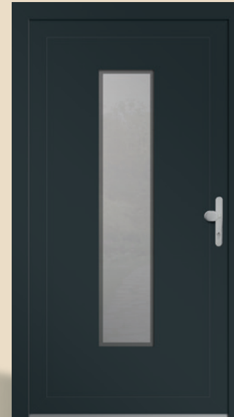
MKS01255 | Einsatzfüllung | Anthrazitgrau foliert genarbt | Lichtausschnitt: 280 mm x 1400 mm, mittig | rahmenlos | sandgestrahltes Dekorglas mit klarem Rand | Wechselgarnitur G_0021 auf Langschild, Knauf außen, Aluminium Natur F1 Ausstattung in Abb.: FK1 GG0 DG0 Modell erhältlich als: KA RC2
