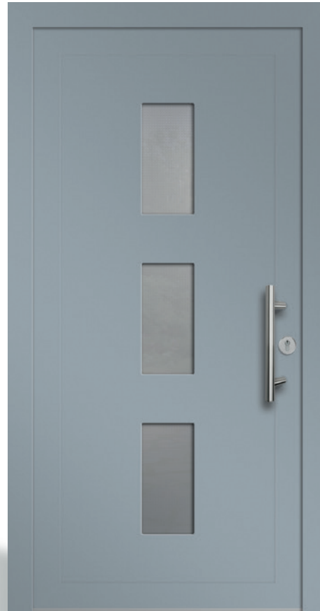
MKS04304 | Einsatzfüllung | Silbergrau foliert genarbt | Lichtausschnitt: 3 x 180 mm x 380 mm | rahmenlos | Orna- mentglas Mastercarré | Stangengriff S_1020, Edelstahl matt, 400 mm | Rundrosette Edelstahl matt Ausstattung in Abbildung: FK1 GG0 OG1 Modell erhältlich als: KA RC2
