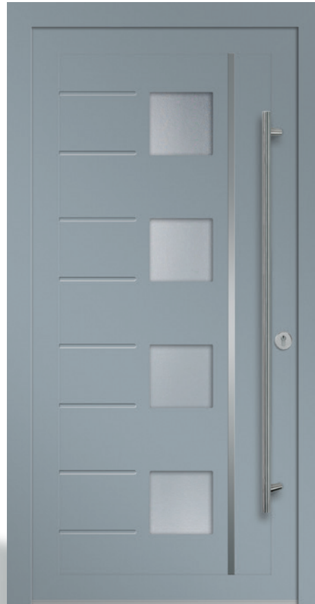
MKS04407 | Einsatzfüllung | Silbergrau foliert genarbt | Lichtausschnitt: 4 x 220 mm x 220 mm | rahmenlos | Orna- mentglas Mastercarré | plannflächig eingelegte Applikation in Edelstahloptik und Nuten außen | Stangengriff S_1120, Edelstahl matt, 1400 mm | Rundrosette Edelstahl matt Ausstattung in Abbildung: FK1 GG1 OG1
