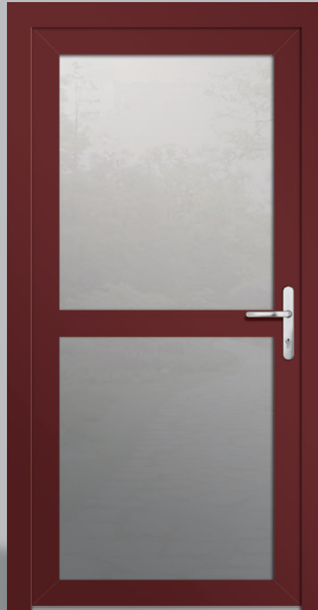
MKS94106 | Konstruktions-Tür | Braunrot foliert genarbt | Ornamentglas Satinato | Drückergarnitur G_0023 auf Langschild, Knauf außen, Aluminium Natur F1 Ausstattung in Abbildung: FK3 GG0 OG1 Modell erhältlich als: KA RC2
